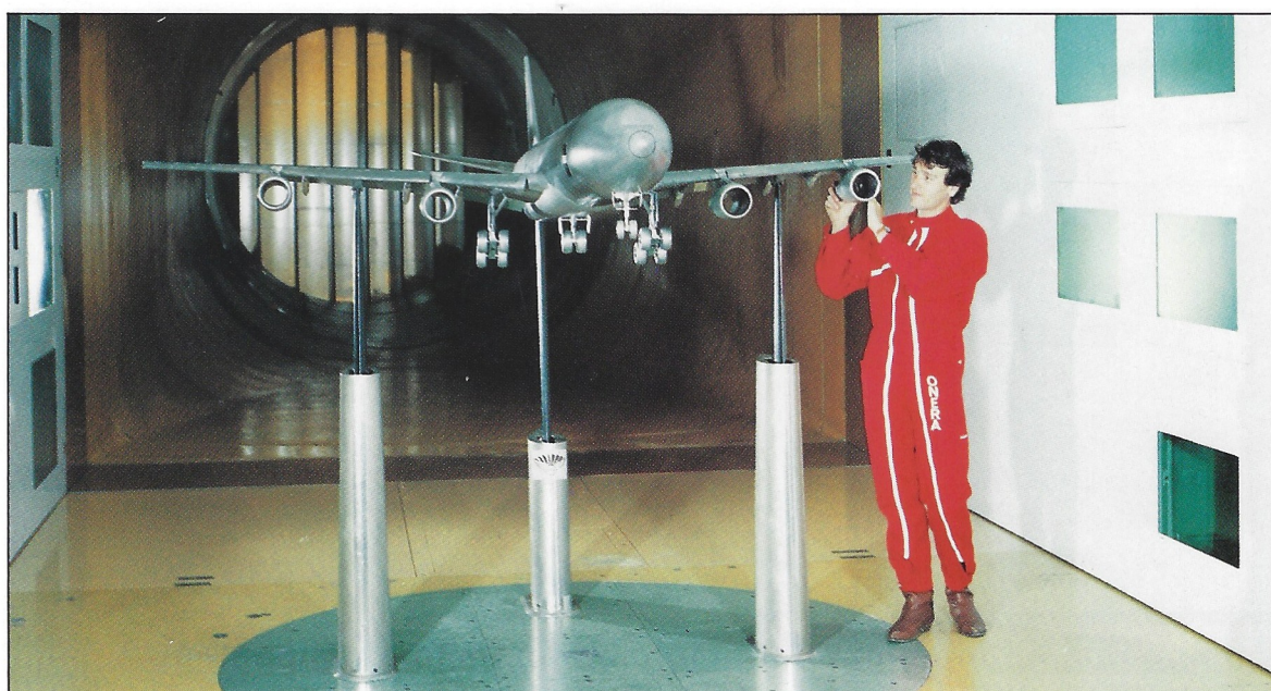
Essai d'une maquette A340 au 1/19 dans la soufflerie F1
