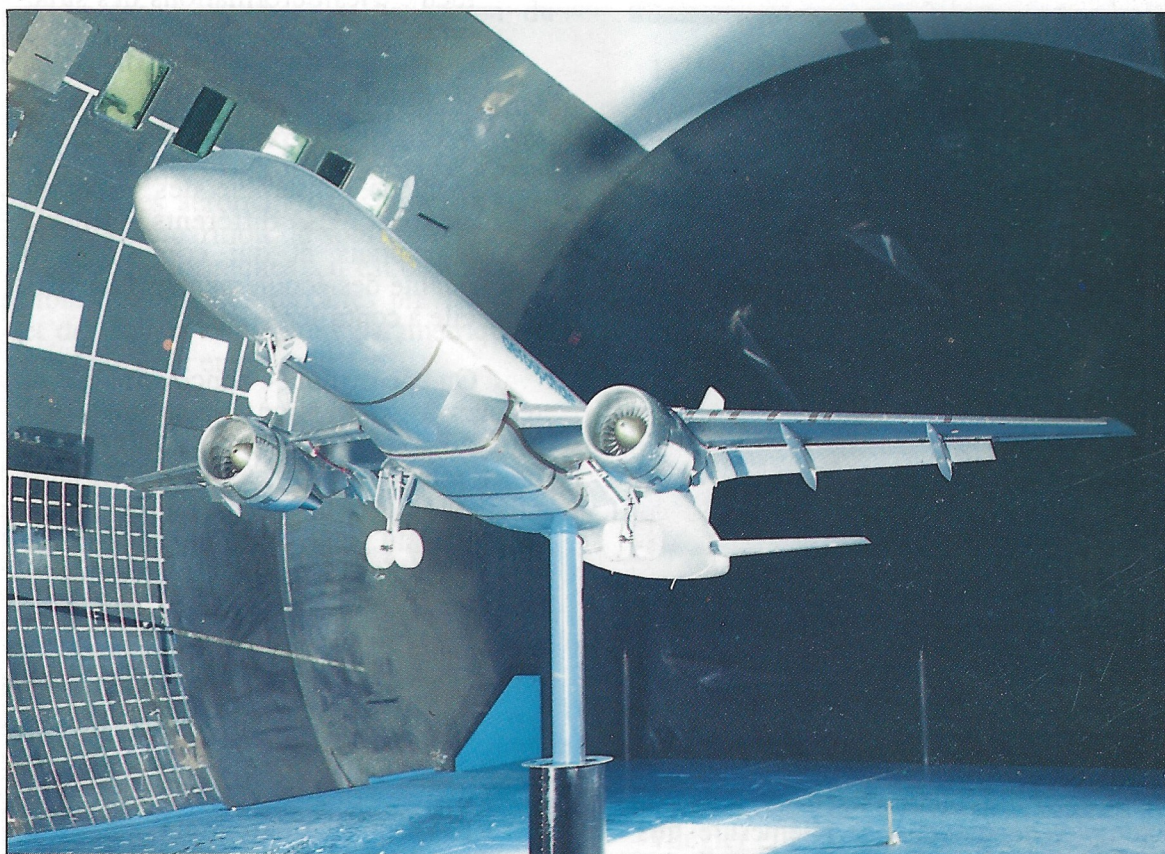
Etude dans la soufflerie S1MA de l'A320 en phase de décollage et d'atterrissage
