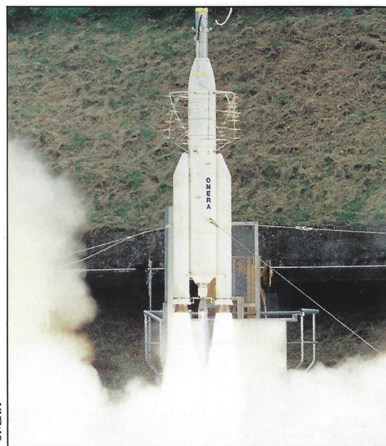
Simulation d'un tir ARIANE V au 1/20 ème
