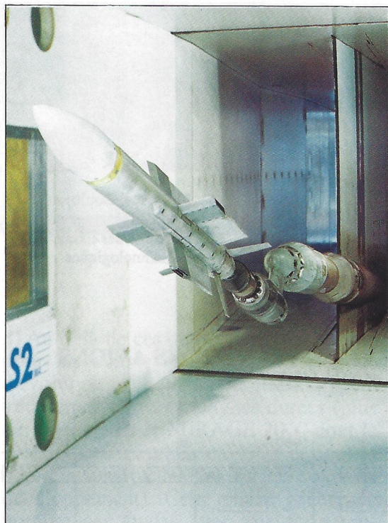
Pif-Paf ASTER Echelle 0,56 dans la soufflerie S2MA avec simulation des jets
